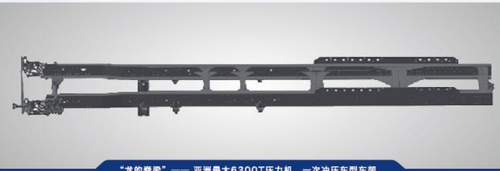
“龙的脊梁”——亚洲最大6300T压力机，一次冲压成型车架
