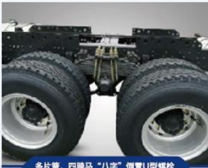
多片簧，四骑马“八字”倒置U型螺栓
