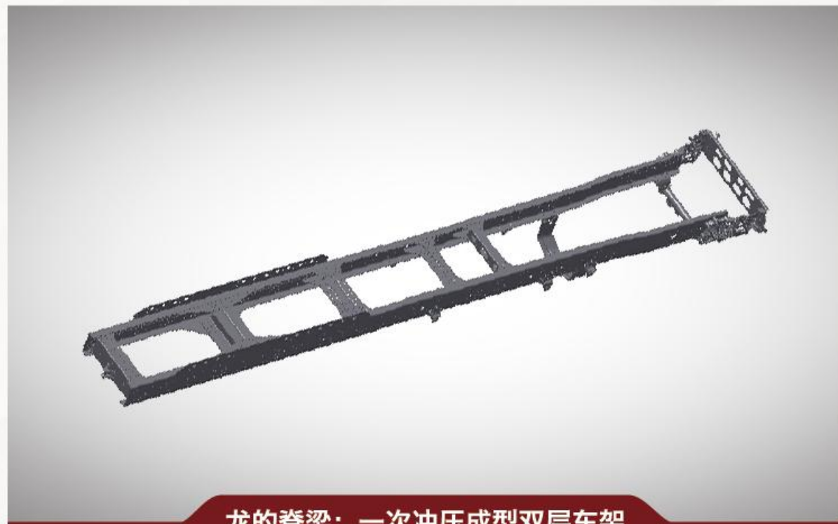
龙的脊梁：一次冲压成型双层车架
