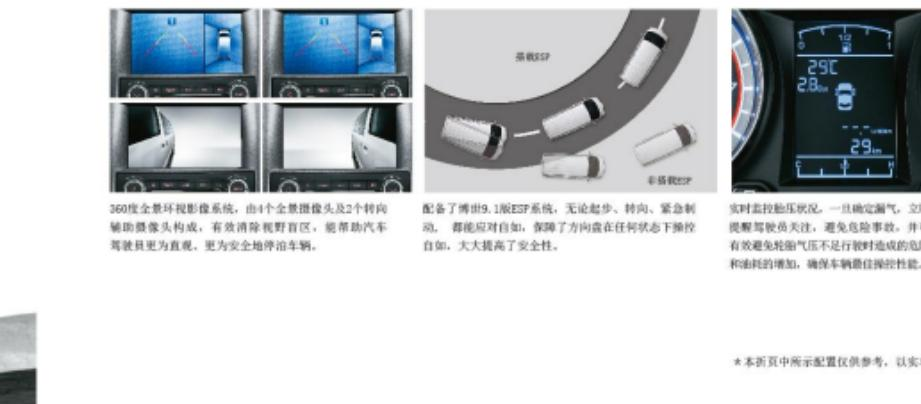
360度全景环视影像系统，由4个全景摄像头及2个转向辅助摄像头构成，有效消除视野盲区，能帮助汽车驾驶员更为直观，更为安全地停泊车辆。
